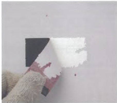
写真-4 布テープによる付着力試験での剥離 photo.4 Peeling-off in bond force test by taping
