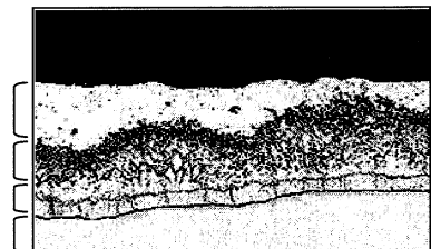
図-1 溶融亜鉛めっき被膜の組織構成
