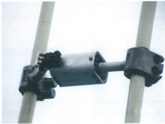
巻頭写真-5 ハンガーロープ制振ダンパーの破断 (明石海峡大橋) (1998)
