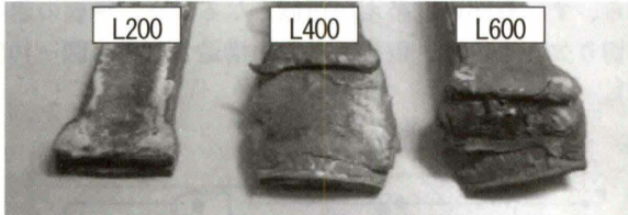
写真-4 短冊試験後（底面テフロンパウダー塗布） Photo 4 Test results (after painting of teflon powder)
