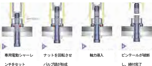
図-7 ワンサイドボルト締め付け工程 Fig.7 Execution method of the one-side bolt
