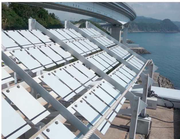
写真-1 大鳴門橋暴露試験
