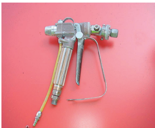
写真-3 エアカーテン工法スプレーガン
