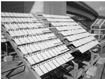
写真-1 大鳴門橋暴露試験
