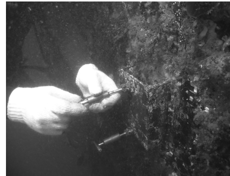
写真-2 テストピース設置状況
