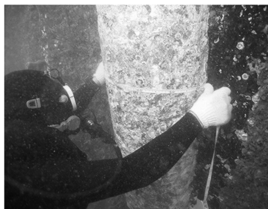
写真-3 形状寸法の計測
