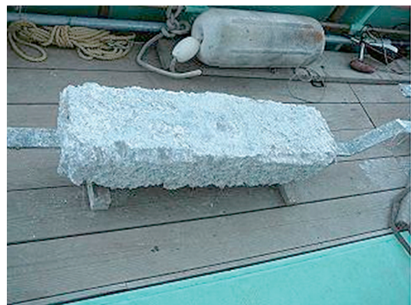
写真-10 回収した陽極 (4A) Salvaged anode from 4A
