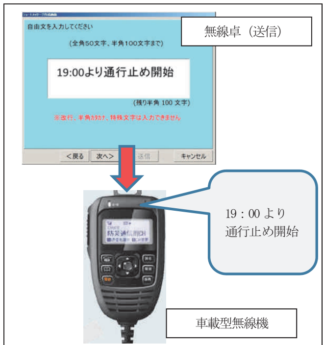
図-7 ショートメッセージイメージの例 2 (無線卓→車載型無線機)
