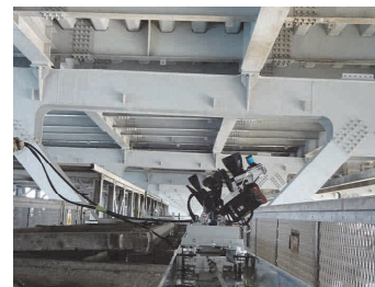
写真-1 亀裂検出装置
