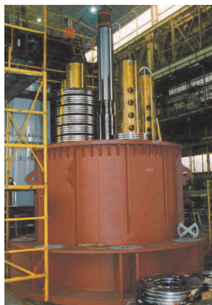
写真-3 製作中のスプリング沓
