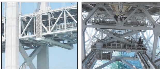
写真-8 大鳴門橋の桁外面作業車と桁内面作業車 Photo 8 Girder maintenance vehicles of Ohnaruto Bridge
