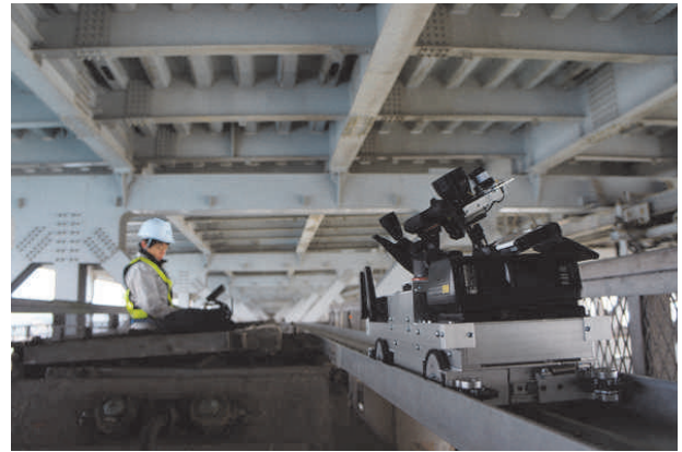
写真-3 亀裂検出システムによる点検状況 Photo 3 Inspection of steel deck by developed system
