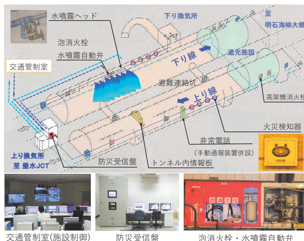
図-1 舞子トンネル非常用施設の設備 配置図
