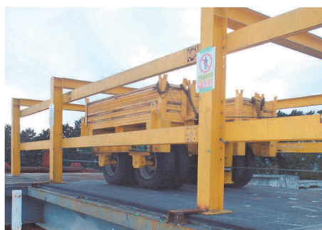
写真-1 屋外輪荷重試験
