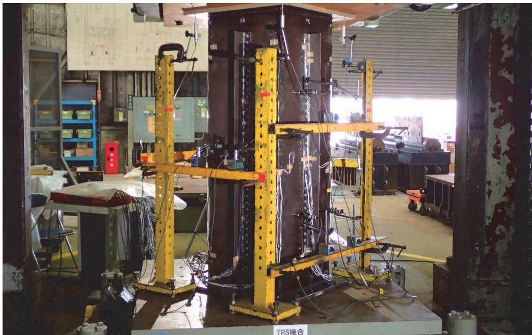
写真-1 座屈耐荷力試験状況（TRS 接合）
