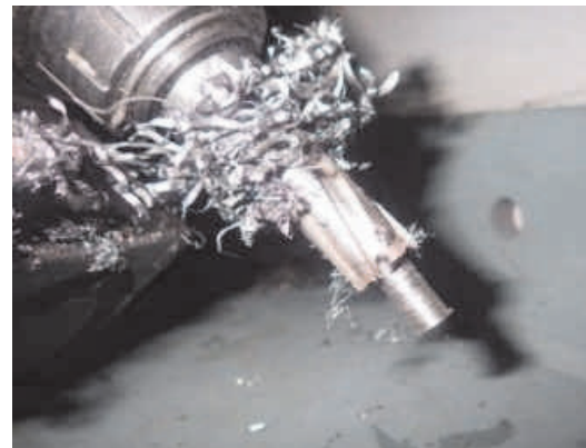
写真-8 孔明け Photo 8 Drilling
