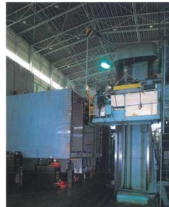
主塔部材の工場製作 部材の上下面を特殊な機械で切削
